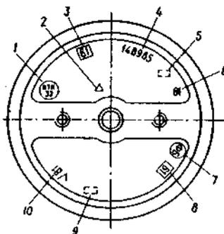
**Рис. 26.** Знаки и клейма на правом торце оси колесной пары локомотива с внутренними буксовыми шейками, а также колесных пар электровозов с наружными буксовыми шейками на подшипниках скольжения и тепловозов с торцовыми упорами качения:
