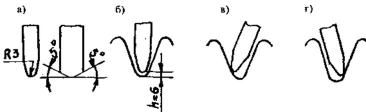
Рис. 7 Наклеп впадины зубчатого колеса (h — зона упрочнения впадины)
