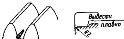
Рис. 6 Форма допустимой выкружки
