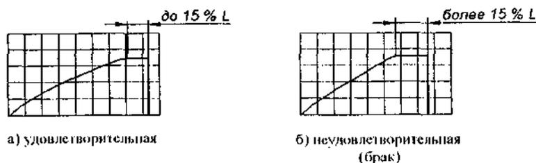
Рисунок 13 - Диаграммы с горизонтальной прямой в конце запрессовки
