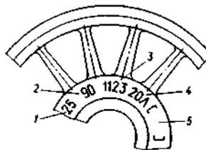
**Рис. 29.** Знаки и клейма на наружном торце ступицы центра: 1 — условный номер предприятия-изготовителя; 2 — год (две последние цифры) изготовления; 3 — порядковый номер центра по системе нумерации предприятия-изготовителя; 4 — обозначение марки стали; 5 — клейма технического контроля предприятия-изготовителя и представителя заказчика
