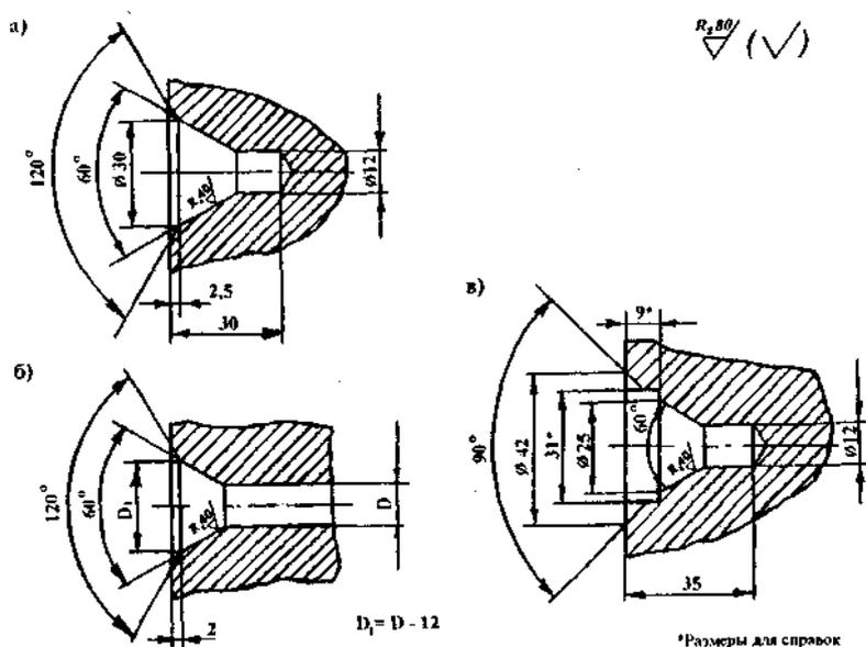
**Рис. 2.** Отверстия центровые для осей: а — несверленных; б — сверленных; в — с торцевым креплением подшипников гайкой
