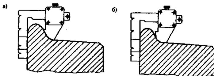
**Рис. 1.** Шаблон для контроля вертикального подреза гребня бандажа
