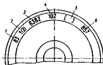
**Рис. 30.** Знаки и клейма наружной боковой поверхности обода цельнокатаного колеса: 1 — год (две последние цифры) изготовления; 2 — марка стали колеса; 3 — номер плавки; 4 — условный номер предприятия-изготовителя; 5 — клейма технического
